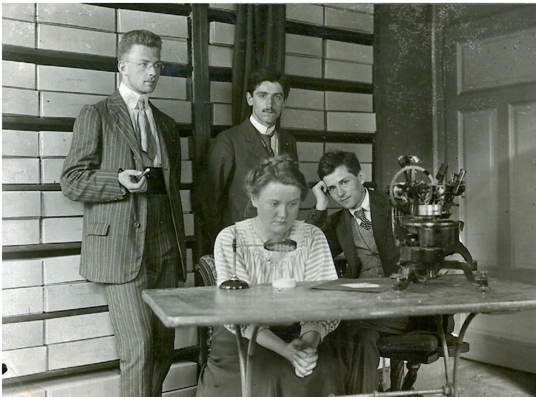
4-9. Studenten am Mineralogisch-Krystallographischen Institut, mit einem zweikreisigem Reflexionsgoniometer von Goldschmidt/Stoë. V.l.n.r.: Hr. Weinreich, Hr. Treumer, FrL. Rinnecker, Hr. Neff. An der Rückwand die Mineraliensammlung des Instituts in Kartons. Um 1928.
