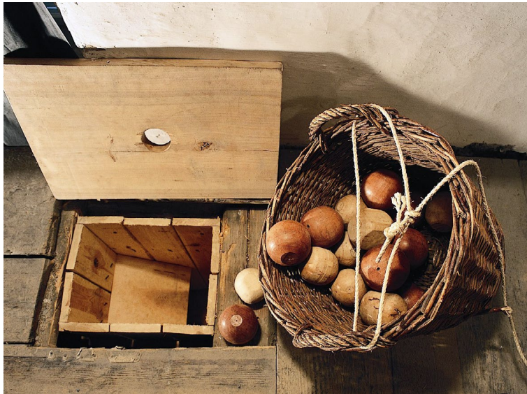
Abbildung 13. Donnerschacht mit unterschiedlich schweren Kugeln.
