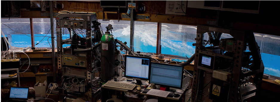
Abbildung 3: Im ringförmigen Heidelberger Aeolotron wurden während des SOPRAN-Projekts 2014 Gasaustauschmessungen mit Meerwasser durchgeführt. Im Gegensatz zu linearen Kanälen können durch die unendliche Wechselwirkungszeit zwischen Wind und Wellen sich viel größere Wellen aufbauen als in linearen Kanälen (Foto B. Jähne). CampusTV-Bericht .
