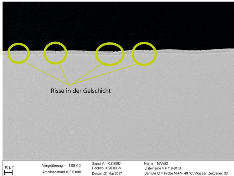
**Abbildung 7.** Die rasterelektronenmikroskopische Aufnahme in 100facher Vergrößerung zeigt im Querschnitt desselben Glases wie Abbildung 6 Risse in der Gelschicht.
