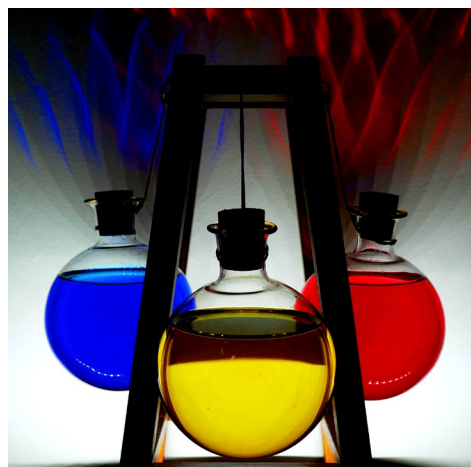
Abbildung 2. Drei Kugeln mit Flüssigkeiten – Rotwein, Safranextrakt (Gelb) und Lackmusextrakt (Blau). Die Kugeln wirkten als Farbfilter und zugleich als Sammellinsen und fokussierten die Lichtstrahlen.
