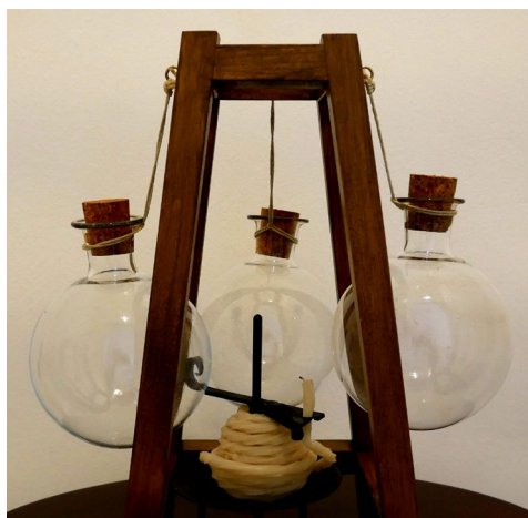
Abbildung 1. Die Schusterkugel, nach dem Prinzip von Leonardo da Vinci, mit einer dünnen Wickelwachs-Kerze, drei Kugeln ohne Flüssigkeiten an einem Trapez-Holzgehäuse.
