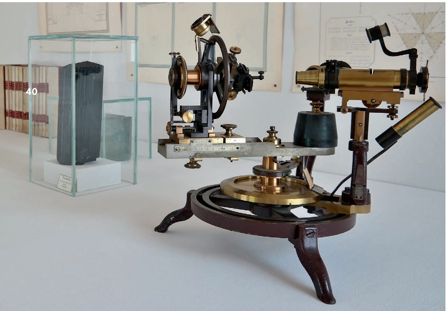
3-4. Ein ›Goldschmidt-Goniometer‹ (vgl. 3-39); links hinten an der Rückwand die vollständigen Bände des Atlas der Krystallformen; dazwischen ein großer Turmalin. 3-4. A ›Goldschmidt Goniometer‹ (cf. 3-39); on the left in the background the complete volumes of the Atlas der Krystallformen ; in-between a large turmaline.
