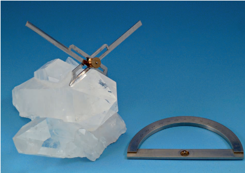
3-37. Anlegegoniometer: Winkelmessung am Kristall
