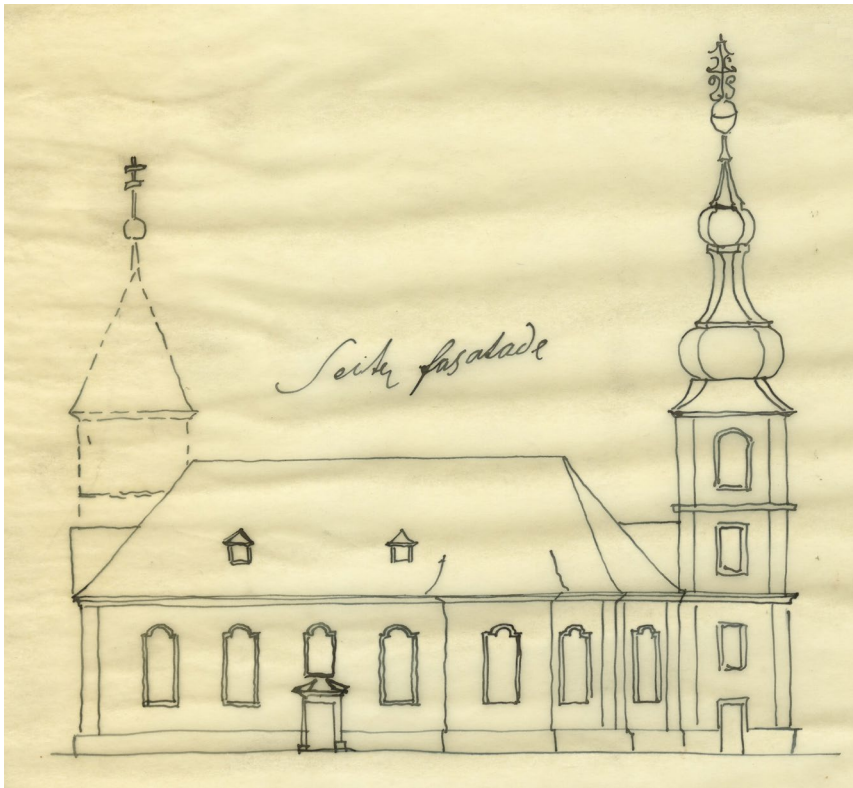
Abb. 5. Diese Skizze von Baumeister Franz Wilhelm Rabaliatti zeigt den bisherigen Kirchturm (gestrichelt) von St. Pankratius in Kombination mit seiner Idee von einem neuen Turm (Schwetzingen, Stadtarchiv, NL Blank 62).
