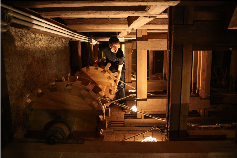
Abbildung 12. Kulissenschieber in der Unterbühne während des jährlichen Ekhof-Festivals.
