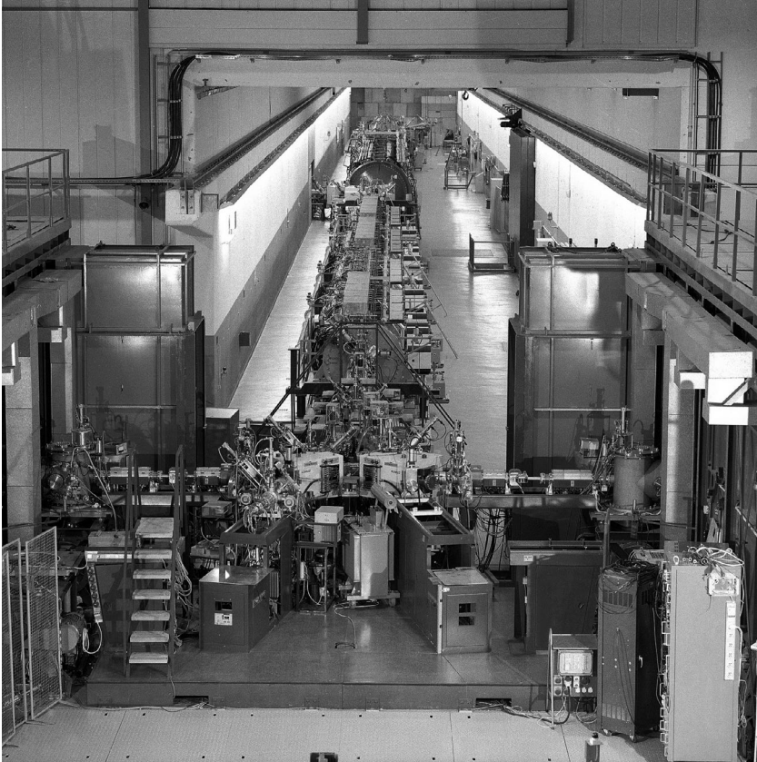
ABBILDUNG 7.12 Der von Schmelzer konzipierte UNILAC-Beschleuniger. Im Vordergrund steht die Quelle, an die sich der 115 m lange Linear-Beschleuniger anschließt.
