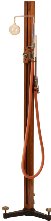
ABBILDUNG 3.14 Das von Jolly konstruierte Gasthermometer.
