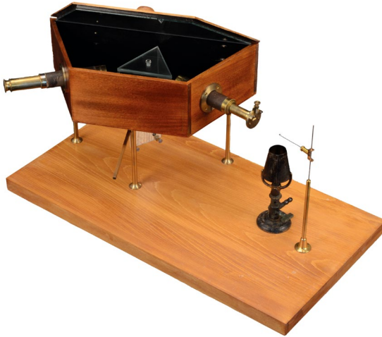
ABBILDUNG 3.19 Nachbau von Kirchhoffs und Bunsens Spektralapparat.
