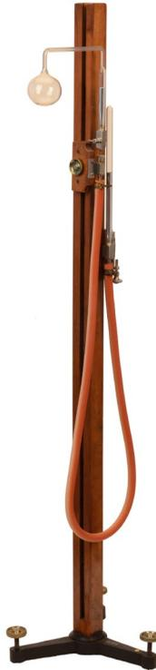
ABBILDUNG 3.14 Das von Jolly konstruierte Gasthermometer.
