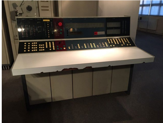
Abbildung 137. VEB Robotron/Karl Claus Dietel, Teile der Großrechenanlage R300 mit Bedientisch Typ 201 (VEB Robotron-Elektronik Radeberg, 1967) und zwei Lochkarten-Lesestanzeinheiten Typ 429 (VEB Büromaschinenwerk Sömmerda, um 1965), Standort: Sächsisches Industriemuseum Chemnitz, Leihgabe der Technischen Sammlungen Dresden.
