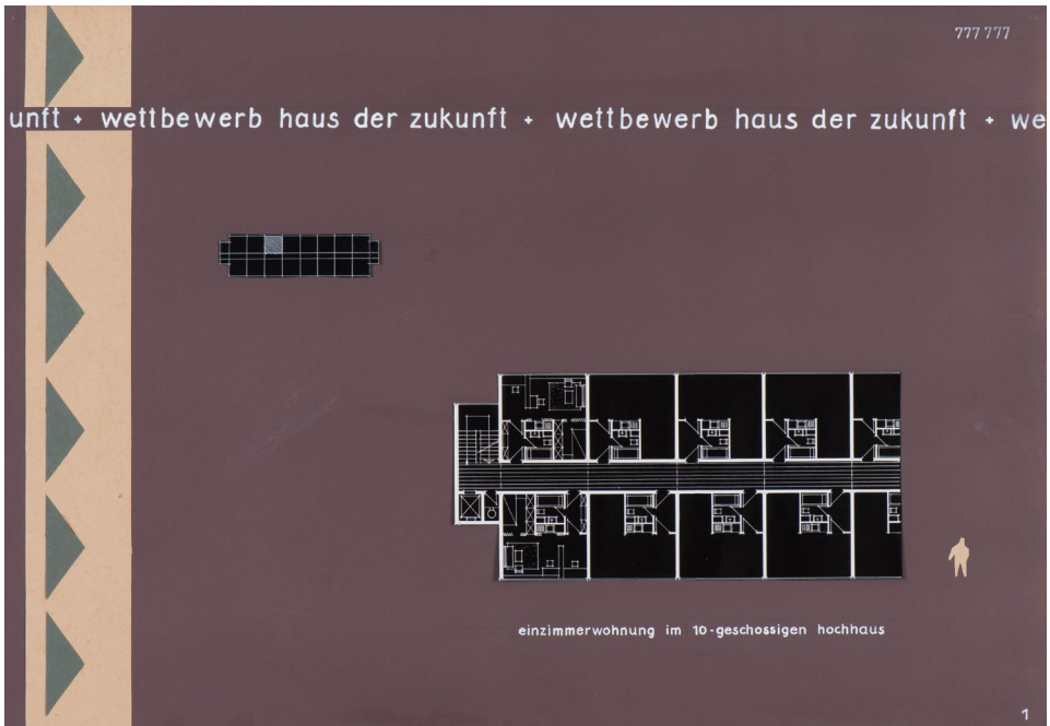
Abbildung 120. Kollektiv Schulrabe, Einreichung der HAB Weimar für den FDJ-Wettbewerb »Das Haus der Zukunft« an der HAB Weimar, 1961, 3. Preis, Grundrissentwürfe für Einzimmerwohnungen im 10-geschossigen Hochhaus, Blatt 1.
