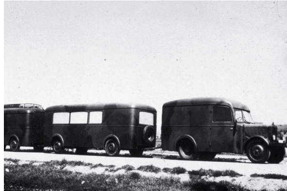
Abbildung 5.15: Die von Martin Kirschner im Jahr 1938 entwickelte Fahrbare Chirurgische Klinik, ein Gespann aus Zugmaschine und zwei jeweils zweiachsigen Anhängern, zur Versorgung des verletzten Patienten am Unfallort.
