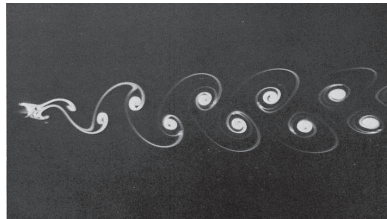
Abbildung 6.10: Instationäre „von Kármánsche Wirbelstraße“ bei Re = 100 (Experiment im Strömungskanal).
