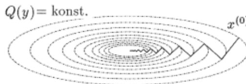
Abbildung 4.1: Niveaulinien des quadratischen Funktionals in zwei Dimensionen und „Zickzacking“ des Gradientenverfahrens
