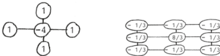
Abbildung 3.4: Differenzensterne: „5-Punkte-Stern“ (links) zur Approximation von \Delta und „9-Punkte-Stern“ (rechts) zur Approximation von -\Delta .
