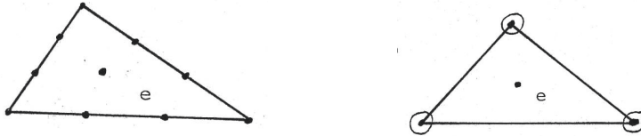
Abbildung 3.12: Knotenpunkte der (konformen) kubischen Ansätze ( e = T )
