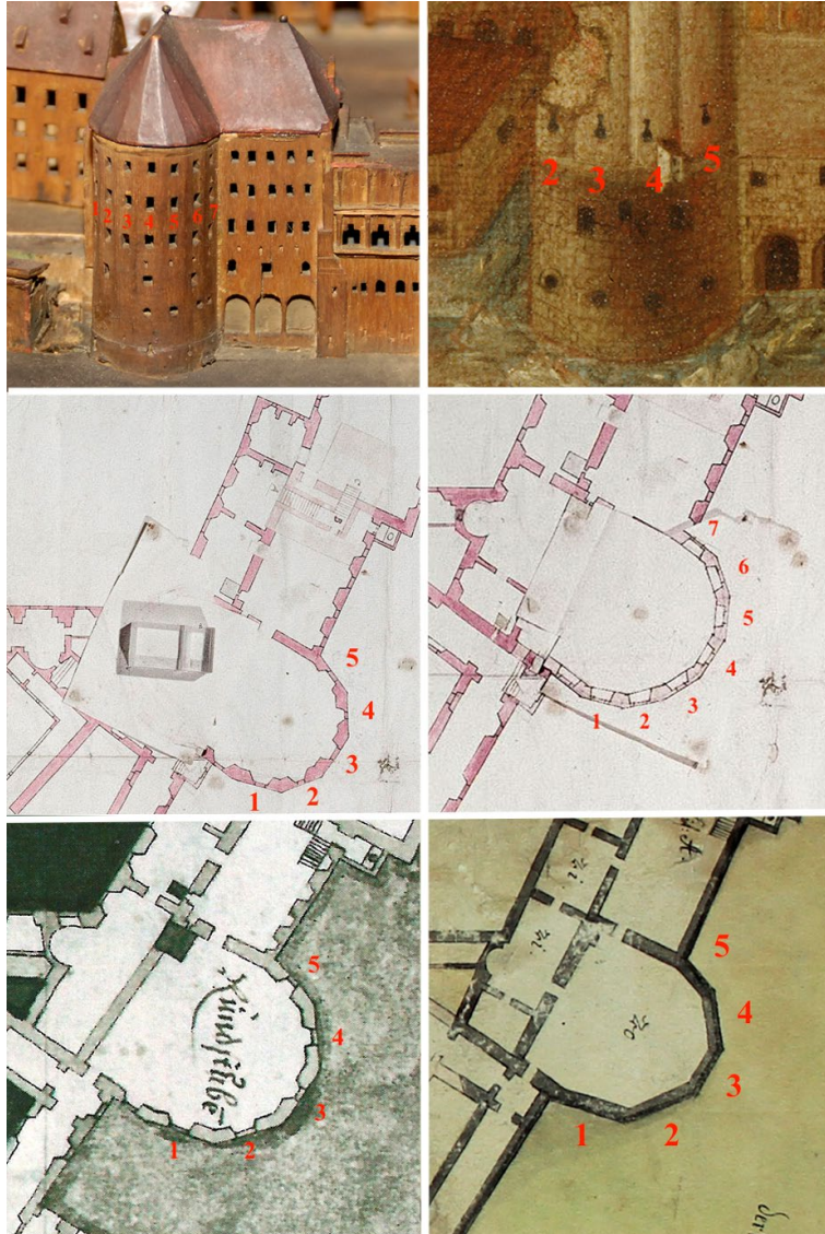
Abbildung 76. Polygonalität des Rundstubenturms, Montage, Sandtner 1570, Brandbild 1750, Pariser Plan 1630a, Tambachplan 1630, Brandplan 1750, JL
